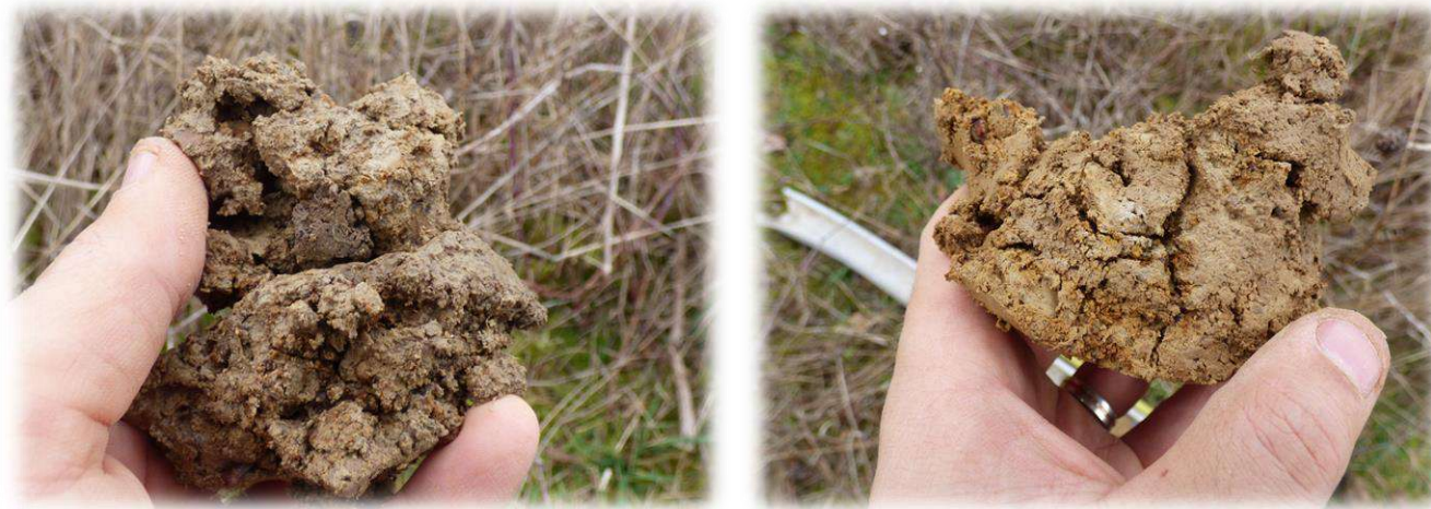
Traits redoxiques peu marqués (taches rouilles éparses) mis en évidence au niveau de certains horizons superficiels argilo-graveleux
